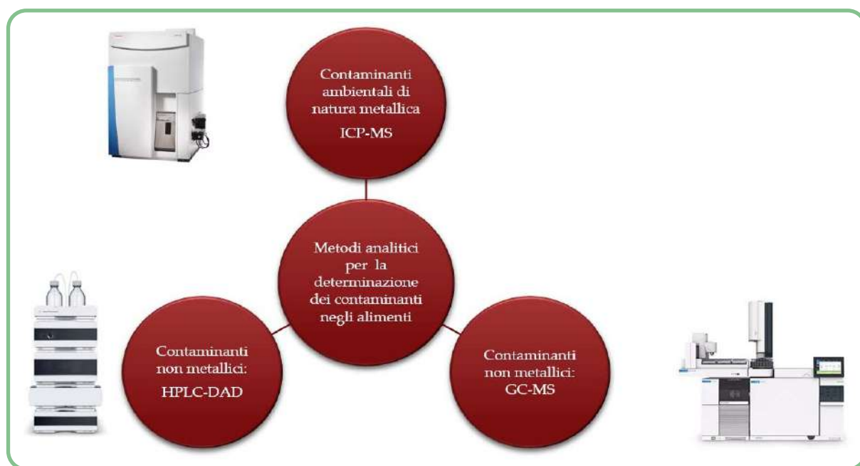
Figura 5: Tecniche strumentali utilizzate per il controllo delle contaminazioni chimiche negli alimenti
